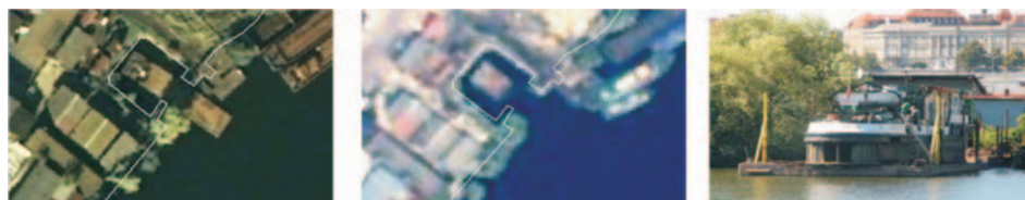
Rys. 10. Dok śródlądowy. Na zdjęciu lotniczym wynurzony, na obrazie satelitarnym częściowo wynurzony, na fotografii wynurzony z pchaczem.
